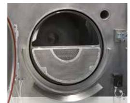
Der Korb kann ausgetauscht werden und somit stehen verschiedene Korbblockungen zur Auswahl. Je nach Formteilgröße exakt auf Ihre Anforderungen zugeschnitten. Die Beladung erfolgt manuell durch die manuell betätigte Außentür. Das Entleeren des Korbes erfolgt automatisch durch die eingebauten Wälzleisten.
