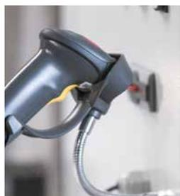
Einfaches und sicheres Datenhandling mit integrierter USB- und LAN-Schnittstelle. Durch das Barcodelesegerät können Rezepturen einfach und sicher abgerufen werden. Integration der Maschinen in firmeninterne Strukturen mit Fernzugriff und Online-Maschinenzugriff sind möglich. OPC-UA ist als universelle Kommunikationsschnittstelle an allen unseren Maschinen verfügbar.
