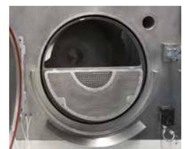
Der Korb kann ausgetauscht werden und somit stehen verschiedene Korbblockungen zur Auswahl. Je nach Formteilgröße exakt auf Ihre Anforderungen zugeschnitten. Die Beladung erfolgt manuell durch die manuell betätigte Außentür. Das Entleeren des Korbes erfolgt automatisch durch die eingebauten Wälzleisten.
